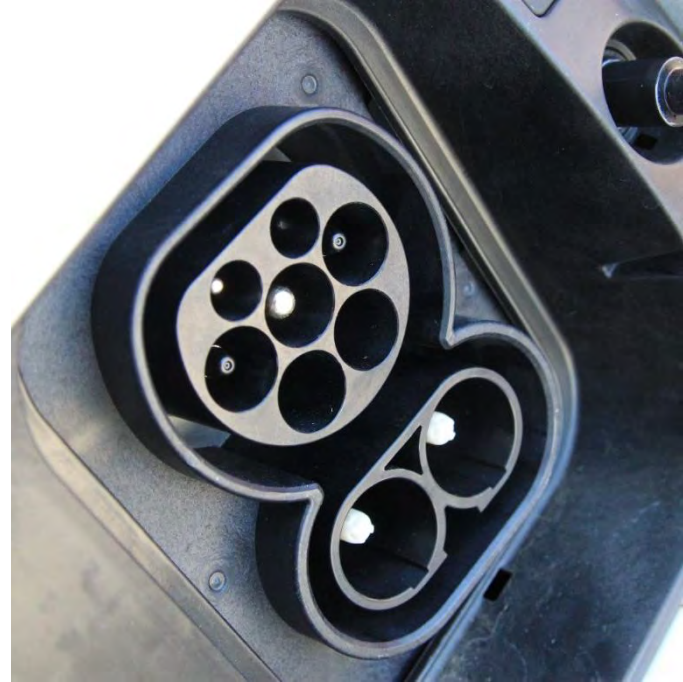
CCS-Stecker Gleichstromladung 20 – 350 kW
